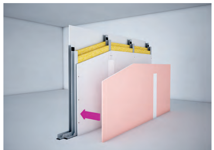
Einseitige Ertüchtigung mit Flamtex A1 und Siniat Fugenspachtel bei einseitiger Brandbeanspruchung
